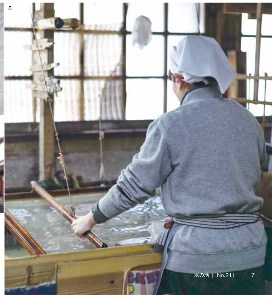
6. 大洲和紙は、書道用紙の他にも障子用紙として寺院や茶室、高級住宅などに使われています。高級和紙としての人気の高い伝統工芸品です 7-8. 伝統の「流し漉き」技法で大洲和紙を生産する天神産紙工場。昔ながらの道具を使用して、職人1人あたり1日で約200~300枚もの和紙を漉いています
