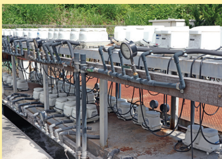
上は5人型の家庭用浄化槽の組み立て作業。ロール状の黒い部材「接触材」によって安定した水質が得られる。下は浄化槽の微生物に空気を送り込むブローの、5年以上に及ぶ耐久試験の様子。ブローも製造する浄化槽メーカーは国内で唯一だという
