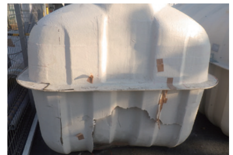
▲破損した浄化槽のイメージ ※写真は試験的に破壊したものに なります。
