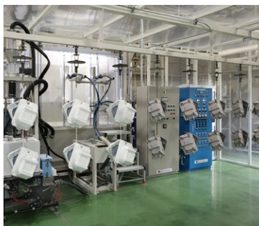
▲塗装ライン(右側が塗装前、左側が塗装後)
