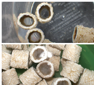
▲生物膜が付着し始めたろ材(上)と、生物膜で閉塞したろ材(下)
