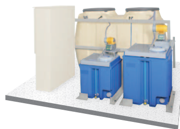
▲「人工透析廃水」pH調整ユニット(設置イメージ) 処理能力：～80床、下水道へ放流 放流水質：pH5.0を超え9.0未満のコンパクトタイプ 連続式中和処理
