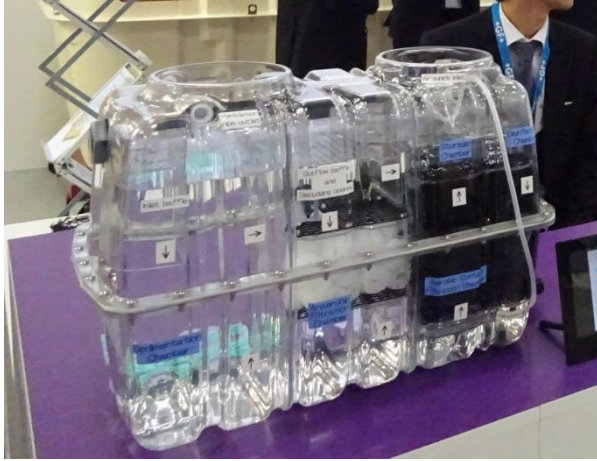
浄化槽の水流がわかる スケルトンミニチュアモデル
