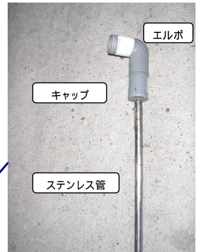
弊社で使用している 逆洗パイプ
