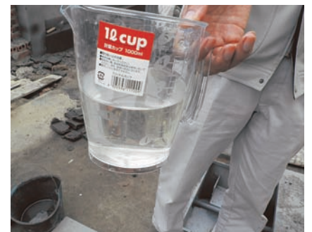
浄化槽への流入水は白濁し、固形物の混入も見られます。浄化槽が設置される前はこのような状態で放流されていましたが、浄化槽で処理されることで透視度50cm以上のきれいな水となっています。（写真左：流入水、右：放流水）
